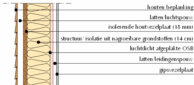
Opbouw 2 – Houtskeletmuur met binnenafwerking uit leemstuc
